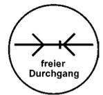
Die Klauenkupplungen werden über ein Bajonettverschluss miteinander verschraubt. Sie können für Hochdruckschläuche verwendet werden. Anders als bei Schlauchkupplungen mit Steckverbindern wird der Querschnitt der Schlauchleitung bei diesen Kupplungen fast nicht reduziert, da der Verschluss nach außen gerichtet ist.
