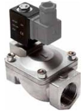
Servogesteuerte Ventile benötigen zum Öffnen oder Schließen eine Druckdifferenz zwischen Ventileingang und -ausgang. Die Druckdifferenz wird als Mindestdruck angegeben.
